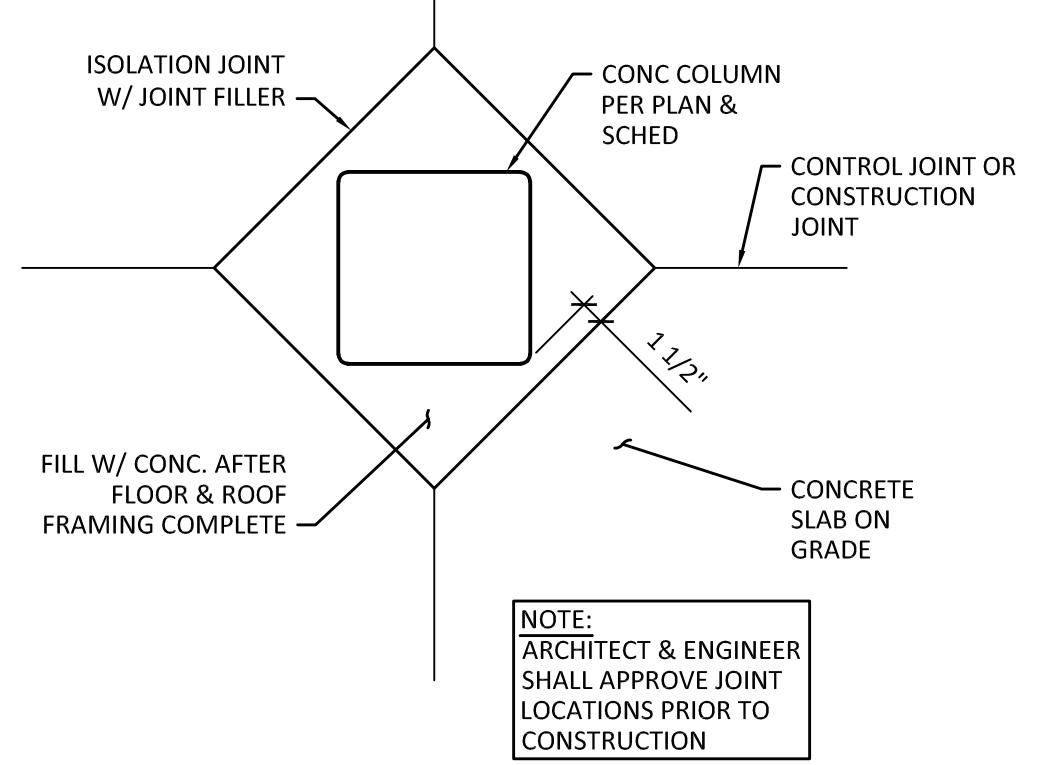
**7 TYPICAL ISOLATION JOINT DETAIL**
