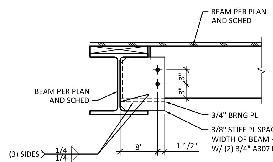
**6 TYPICAL WOOD BEAM TO STEEL BEAM CONNECTION**
