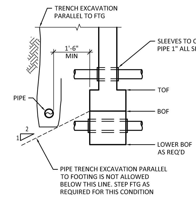
**3 TYPICAL PIPE PENETRATION AT WALLS AND FOOTINGS**
