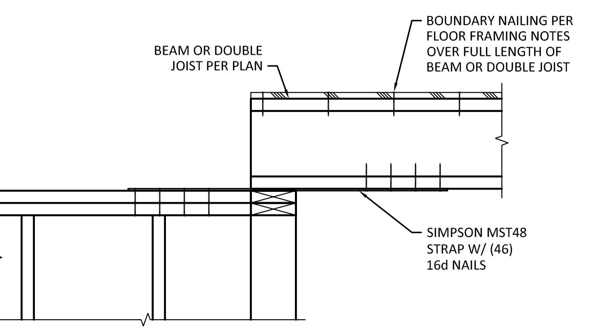
2 TYPICAL DRAG STRUT CONNECTION DETAIL
